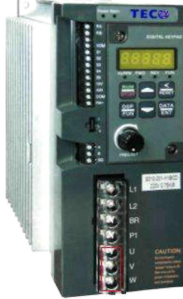
Şekil 2 – Motor Girişleri bağlantısının gösterimi
